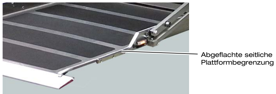
Abbildung 7: Kassettenlifte K70 und K90 mit seitlicher Einfahrt
